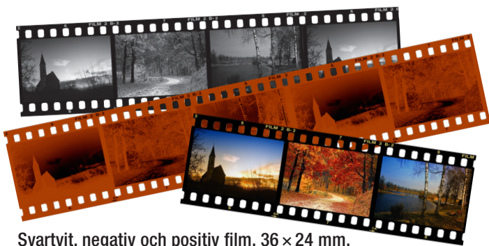
Svartvit, negativ och positiv film, 36 × 24 mm, kallas även småbildaformat, 135-film och 35 mm film.
